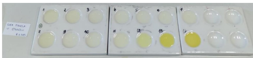
Slika 37. Indikator pripremljen od kore pomela i etanola.
