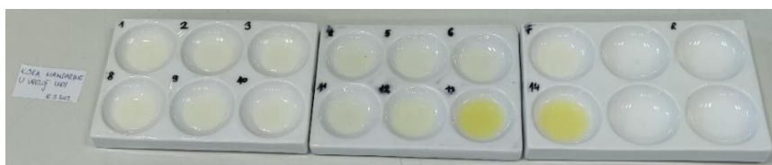
Slika 58. Indikator pripremljen od kore mandarine i vrele vode.
