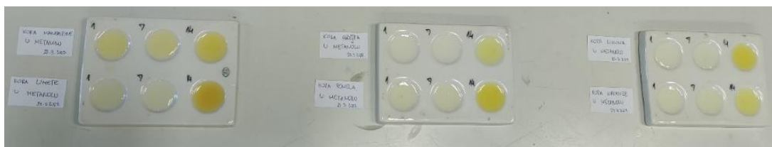
Slika 62. Indikatori pripremljeni od kore citrusa i metanola.
