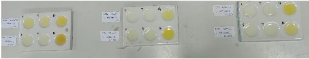
Slika 67. Indikatori pripremljeni s metanolom.
