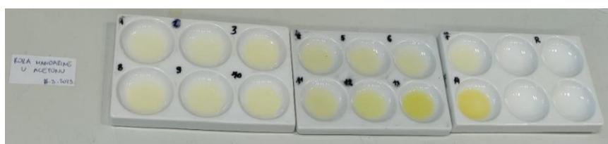
Slika 54. Indikator pripremljen od kore mandarine i acetona.
