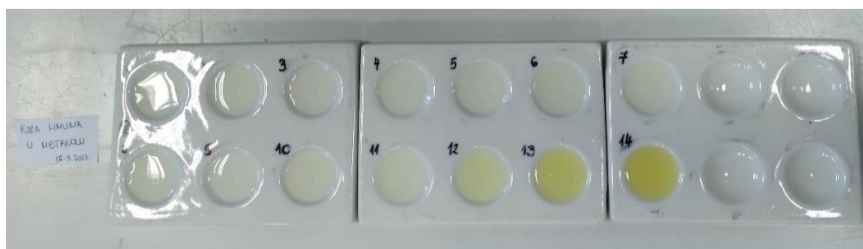
Slika 27. Indikator pripremljen od kore limuna i metanola.
