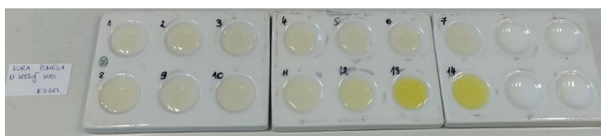
Slika 40. Indikator pripremljen od kore pomela i vrele vode.
