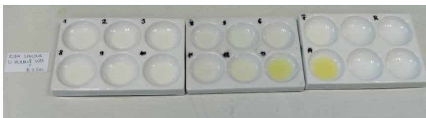
Slika 26. Indikator pripremljen od kore limuna i hladne vode.
