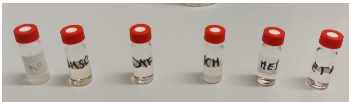
Slika 12. Ispitivanje topljivosti p -kumarinske kiseline.
