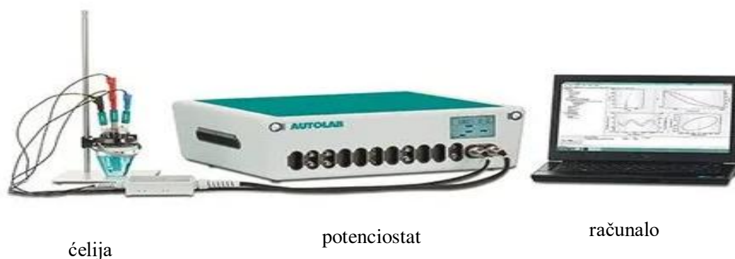
Slika 5. Sustav za voltometrijska mjerenja obuhvaća: voltometrijsku ćeliju, potenciostat i računalo. [31].
