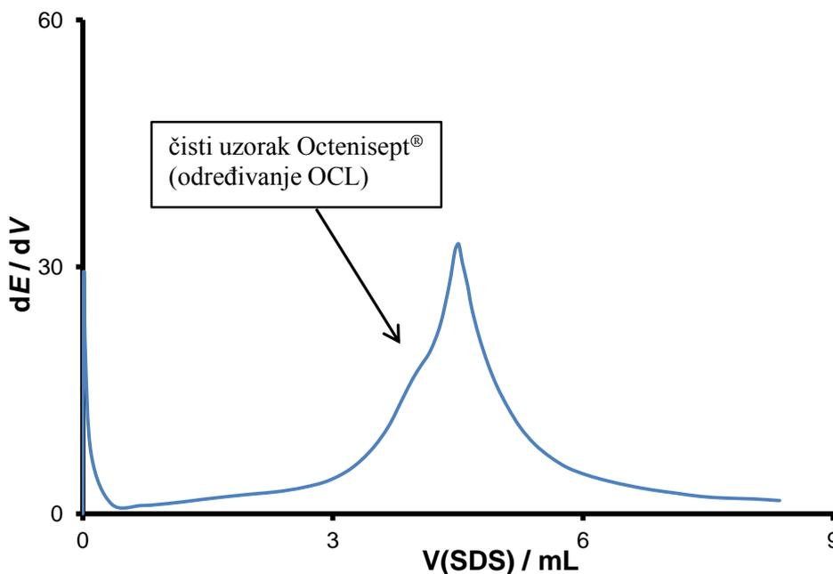
Slika 17. Prva derivacija titracijske krivulje (Slika 16)
