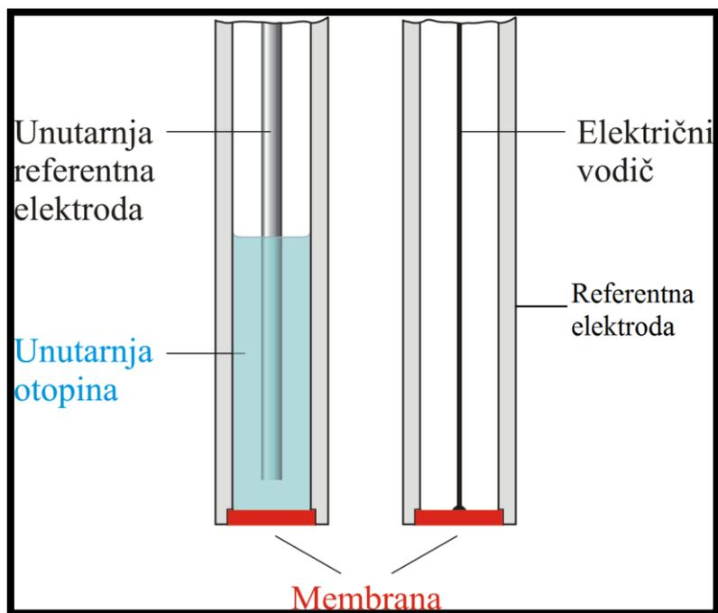
**Slika 12.** Elektrokemijska mjerna ćelija sa glavnim dijelovima - unutrašnja referentna elektroda i elektrolit (unutarnja otopina), referentna elektroda te ionsko-selektivna membrana<sup>8</sup>.
