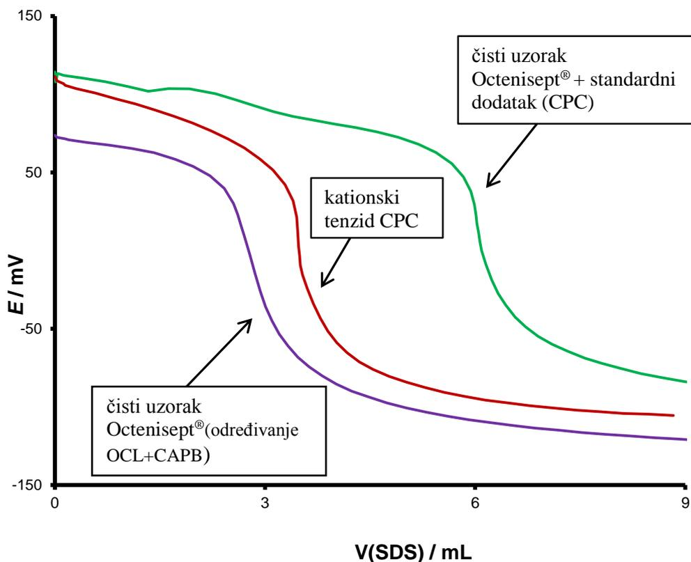
**Slika 14.** Titracijske krivulje ovisnosti elektromotorne sile o volumenu dodanog SDS ( $3,4286 \times 10^{-4}$  mol/L) za određivanje čistog uzorka (Octenisept®), čistog kationskog tenzida CPC ( $3,9143 \times 10^{-3}$  mol/L) te standardnog dodatka (Octenisept® + CPC ( $3,9143 \times 10^{-3}$  mol/L)) pri pH 4,9.
