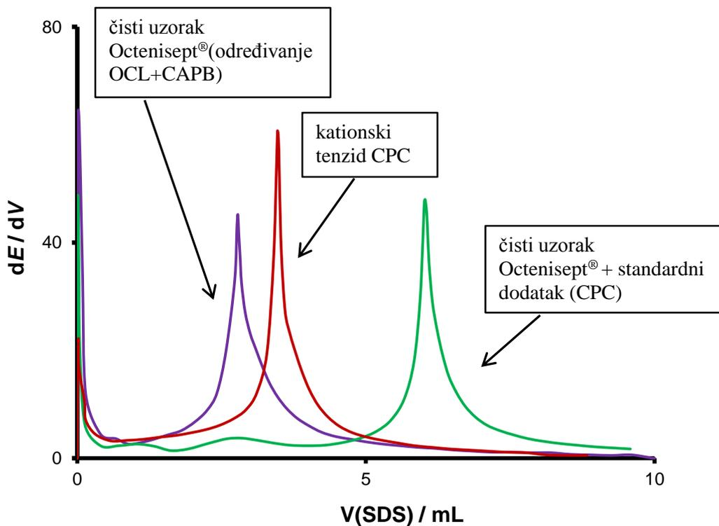
Slika 15. Prva derivacija titracijskih krivulja (Slika 14)
