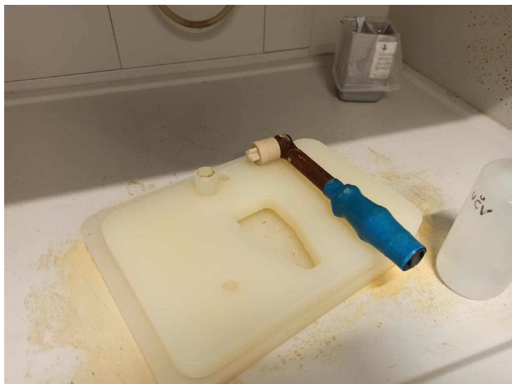
Slika 5. Postolje i odvijač kojim se teflonske kivete fiksiraju u okvir
