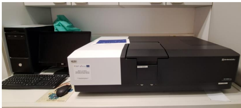
Slika 14. UV/VIS/NIR uređaj za spektrofotometrijsku analizu.
