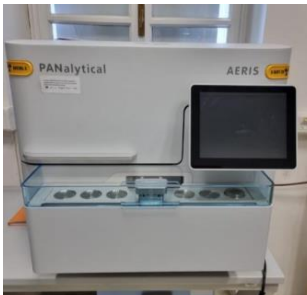
Slika 10. Uređaj za rentgensku difrakciju na prahu.
