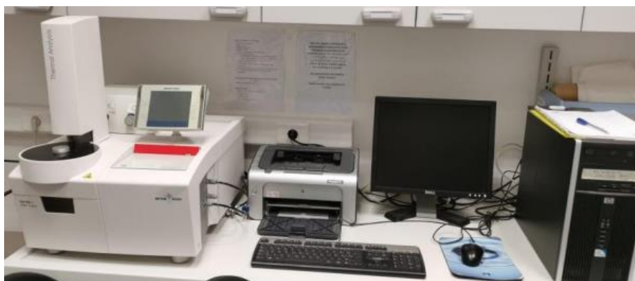
Slika 13. Uređaj za termogravimetrijsku analizu TGA/DSC 1 (Mettler Toledo, SAD).
