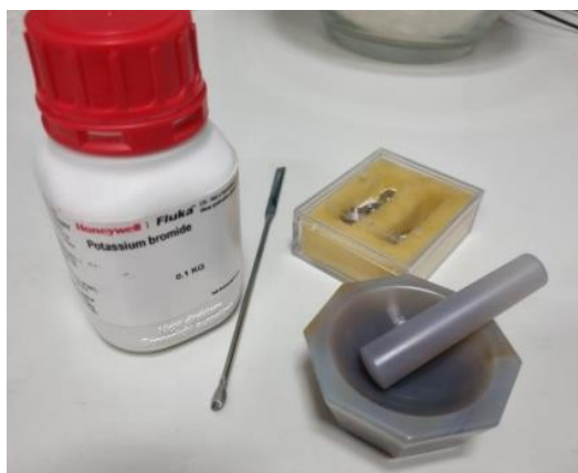
Slika 11. Aparatura i kemikalije za pripremu snimanja na IR spektrofotometru.
