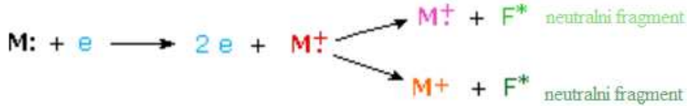
Slika 8. Ionizacijsko razdvajanje molekula uzorka [41]
