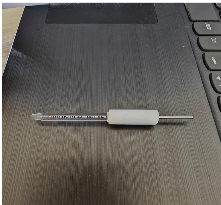
Slika 14: Platinska disk elektroda promjera 50 mikrometara.
