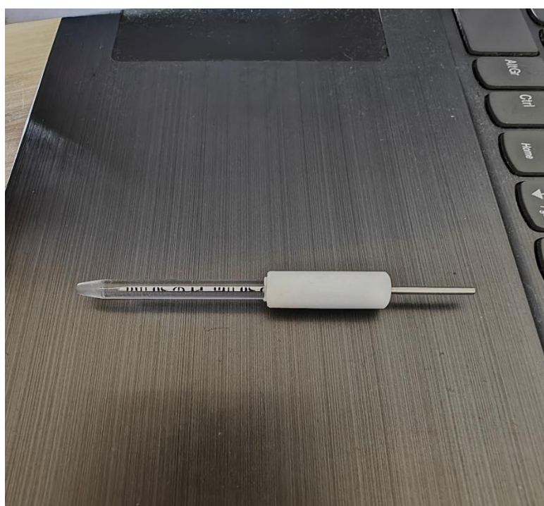
Slika 14: Platinska disk elektroda promjera 50 mikrometara.
