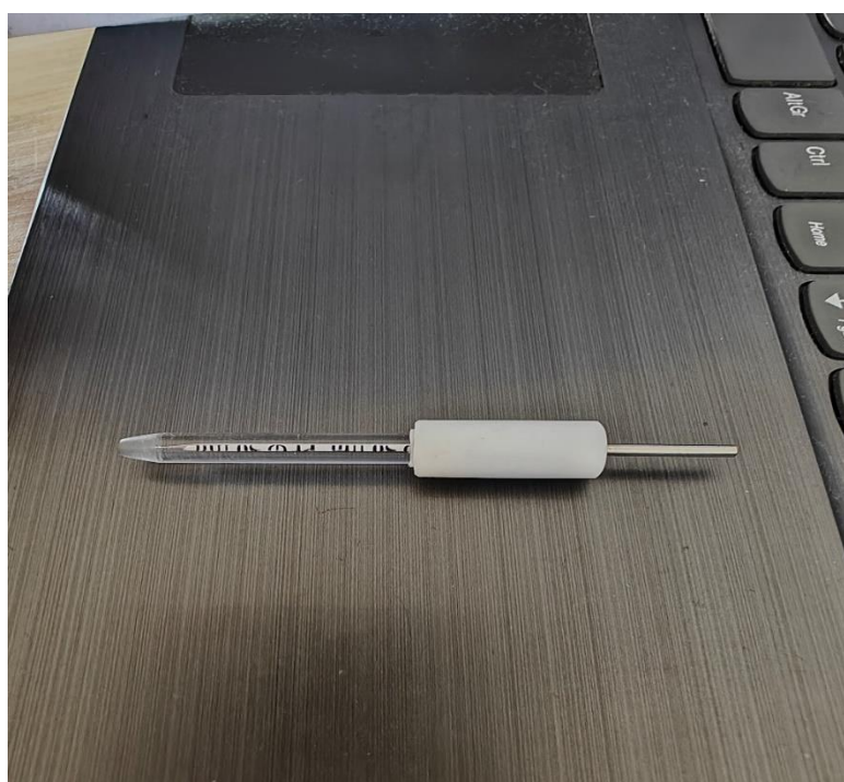
Slika 14: Platinska disk elektroda promjera 50 mikrometara.
