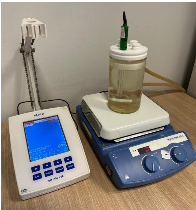
Slika 21. Sustav za sintezu nestabilne faze kalcijeva oksalata.
