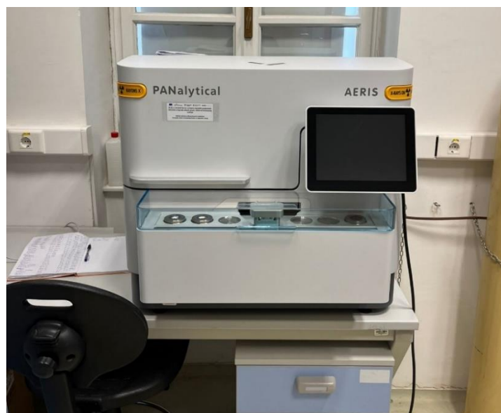
Slika 24. Uređaj za rendgensku difrakciju na prahu.
