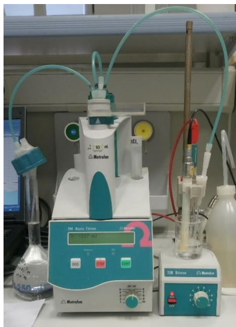
Slika 11. Automatski sustav za doziranje (Metrohm, Švicarska).
