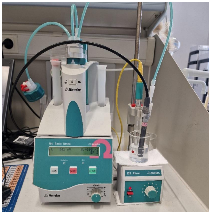
Slika 11. Mjerni sustav korišten za izvođenje potenciometrijskih titracija
