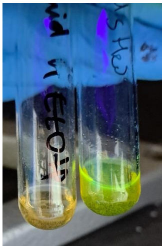
Slika 38. Ispitivanje fluorescencije spoja 2 prije i nakon redukcije s H_2S
