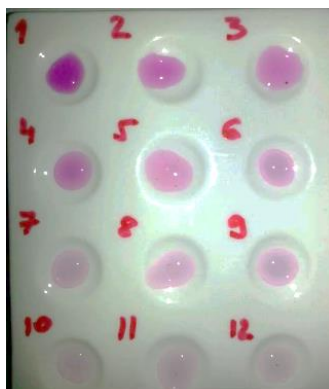
Slika 12. Prikaz jažica sa otopinama KMnO_4 različitih koncentracija
