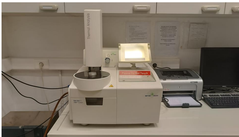
Slika 8. Uređaj za termogravimetrijsku analizu TGA/DSC 1 (Mettler Toledo, SAD.) na Odjelu za Kemiju u sklopu Sveučilišta Josipa Jurja Strossmayera u Osijeku
