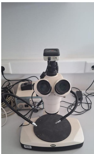
Slika 3. Stereo lupa Smz-169-T1 i digitalna kamera Moticam 3.
