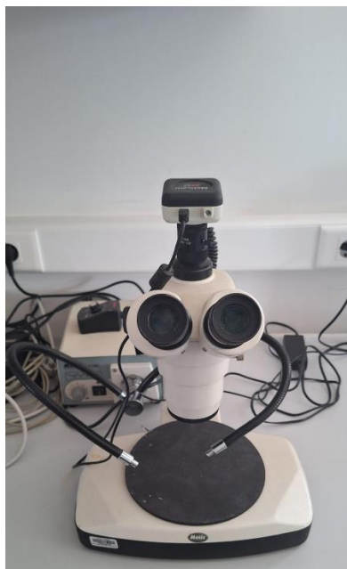
Slika 3. Stereo lupa Smz-169-T1 i digitalna kamera Moticam 3.
