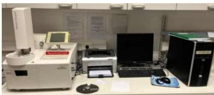
Slika 6. Uređaj za termogravimetrijsku analizu Mettler Toledo System 1.
