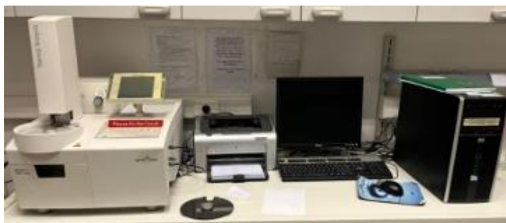
Slika 6. Uređaj za termogravimetrijsku analizu Mettler Toledo System 1.
