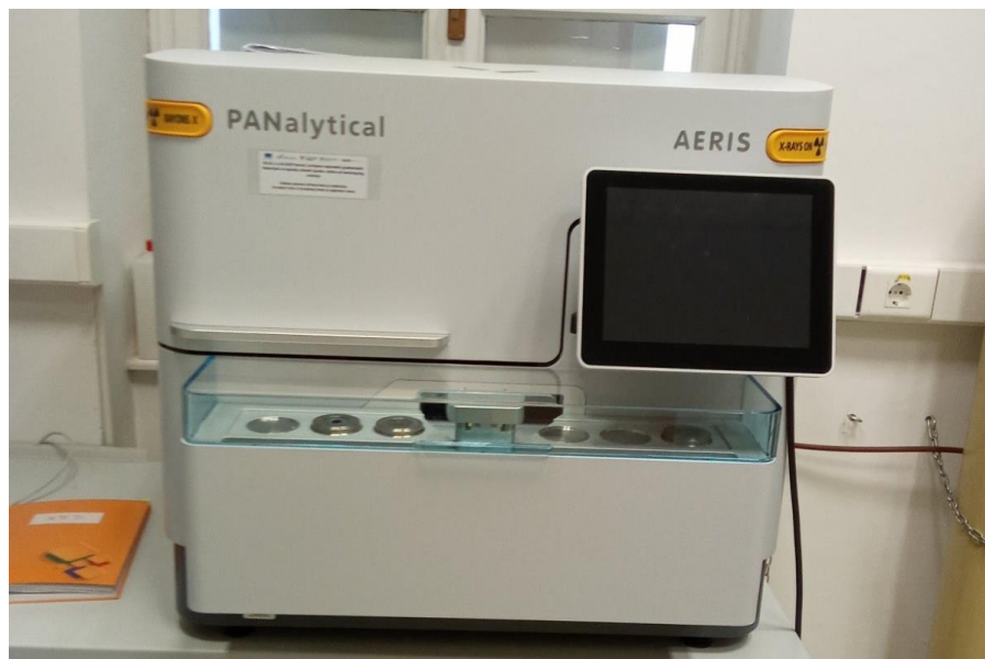
Slika 7. AERIS PANalytical X-ray difraktometar
