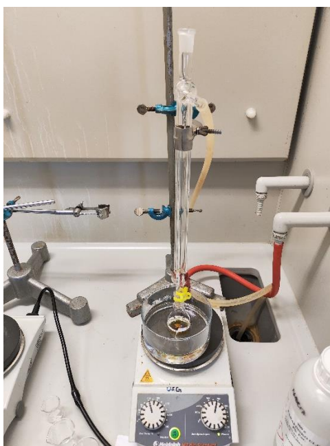
Slika 16. Aparatura za sintezu N-dodecil-4-azido-1,8-naftalimida.
