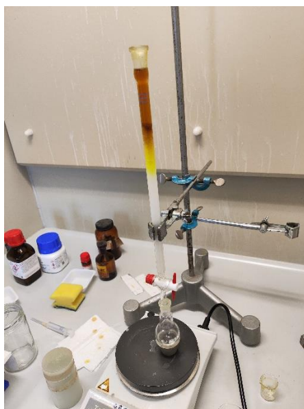
Slika 19. Izolacija dobivenih produkata iz krajnje reakcijske smjese.
