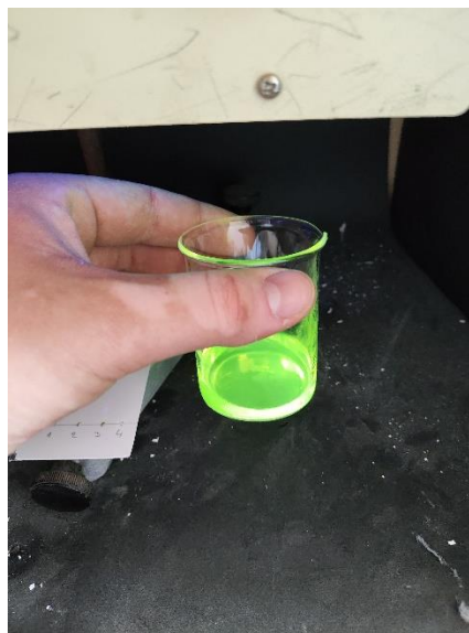
Slika 22. Kromatografska frakcija koja fluorescira žutim svjetlom.
