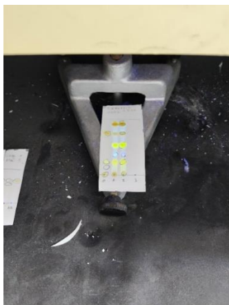
Slika 18. Tankoslojna kromatografija reakcijske smjese prilikom pripreve N-dodecil-4-azido-1,8-naftalimida.
