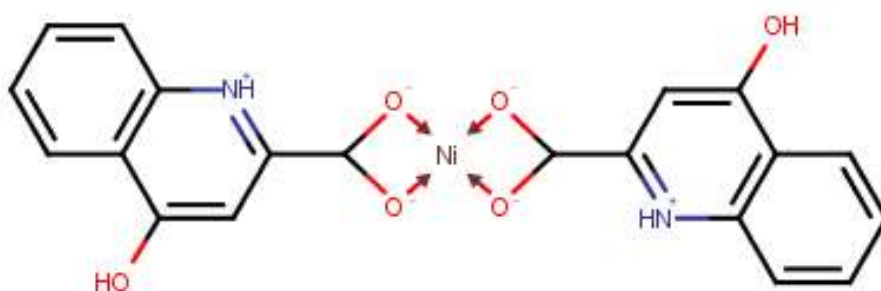
Slika 16. Pretpostavljena struktura [Ni(C_{10}H_8NO_3)_2]
