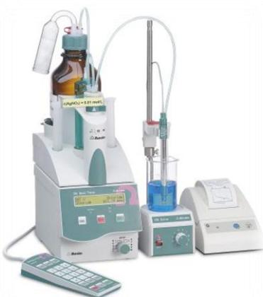
**Slika 9.** Aparatura za titraciju, 794 Basic Titrino
