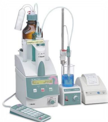
Slika 9. Aparatura za titraciju, 794 Basic Titrino
