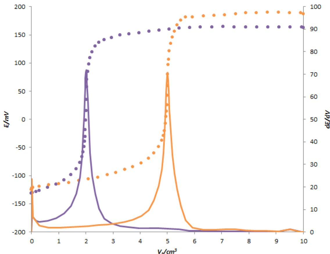
**Slika 11.** Titracijske krivulje (E/mV) dobivene titracijom vodene otopine NaDDS-a koncentracije  $c = 4 \cdot 10^{-3}$  mol/dm $^3$  otopinom CPC-a koncentracije  $c = 4 \cdot 10^{-3}$  mol/dm $^3$  ( ● 2 cm $^3$  NaDDS + 23 cm $^3$  H<sub>2</sub>O, ● 5 cm $^3$  NaDDS + 20 cm $^3$  H<sub>2</sub>O) i derivacijske krivulje (dE/dV) za određivanje točke ekvivalencije pri tim titracijama ( — 2 cm $^3$  NaDDS + 23 cm $^3$  H<sub>2</sub>O, — 5 cm $^3$  NaDDS + 20 cm $^3$  H<sub>2</sub>O)
