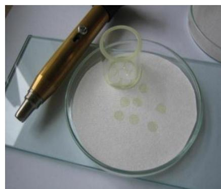
Slika 8. Prikaz izrade membrane ionsko selektivne elektrode
