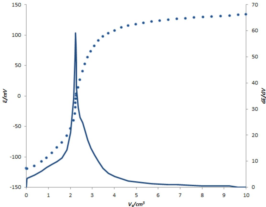
**Slika 10.** Titracijska krivulja (E/mV) dobivena titracijom otopine deterdženta otopinom CPC-a koncentracije  $c = 4 \cdot 10^{-3}$  mol/dm<sup>3</sup> (● čisti deterdžent) i derivacijska krivulja (dE/dV) za određivanje točke ekvivalencije pri toj titraciji (— čisti deterdžent)
