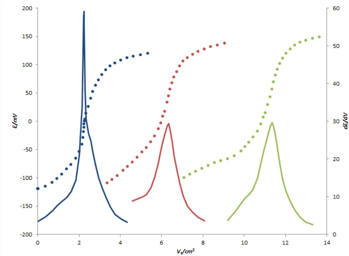
**Slika 13.** Titracijske ( $E/mV$ ) krivulje dobivene titracijama otopine deterdženta otopinom CPC-a koncentracije  $c = 4 \cdot 10^{-3}$  mol/dm $^3$  ( ● čisti deterdžent, ● deterdžent + 2
