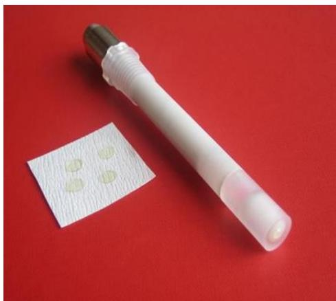
Slika 8. Tenzidna selektivna elektroda za određivanje tenzida
