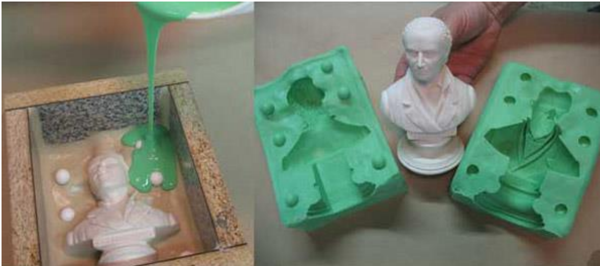
Slika 6. Upotreba silikona za izradu kalupa za repliciranje umjetničkih predmeta.
