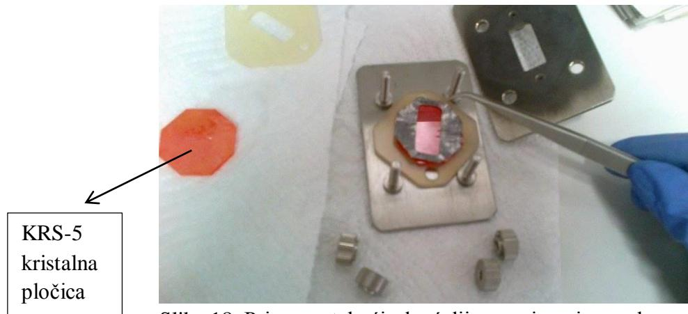
Slika 18. Priprema tekućinske ćelije za snimanje uzorka
