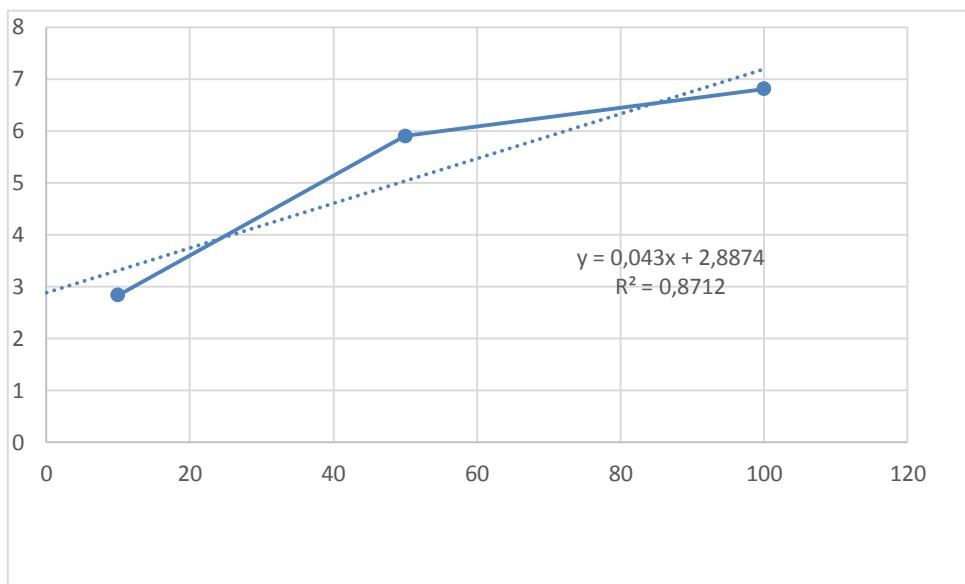
Slika 20. Određivanje intrinzične viskoznosti uzorka LK-7300
