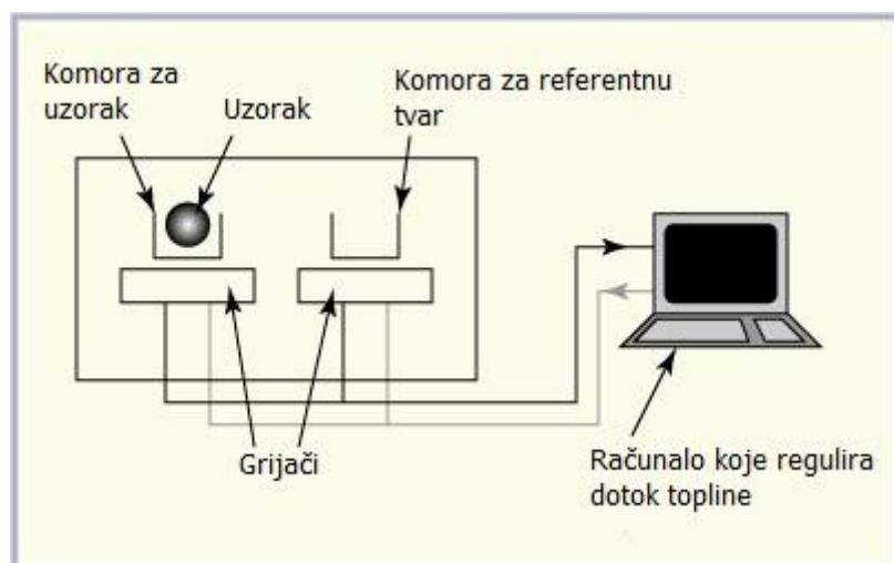
Slika 6. Jednostavna shema uređaja za DSC.
