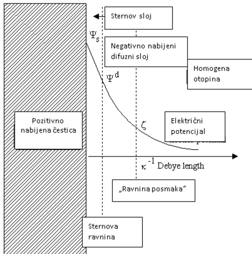
**Slika 1.** Shematski prikaz električnog dvosloja na površini nabijene čestice u otopini
