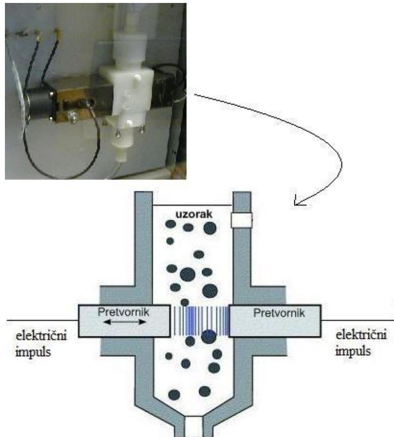
**Slika 6.** Komora za uzorak unutar akustičnog spektrometra DT 1200
