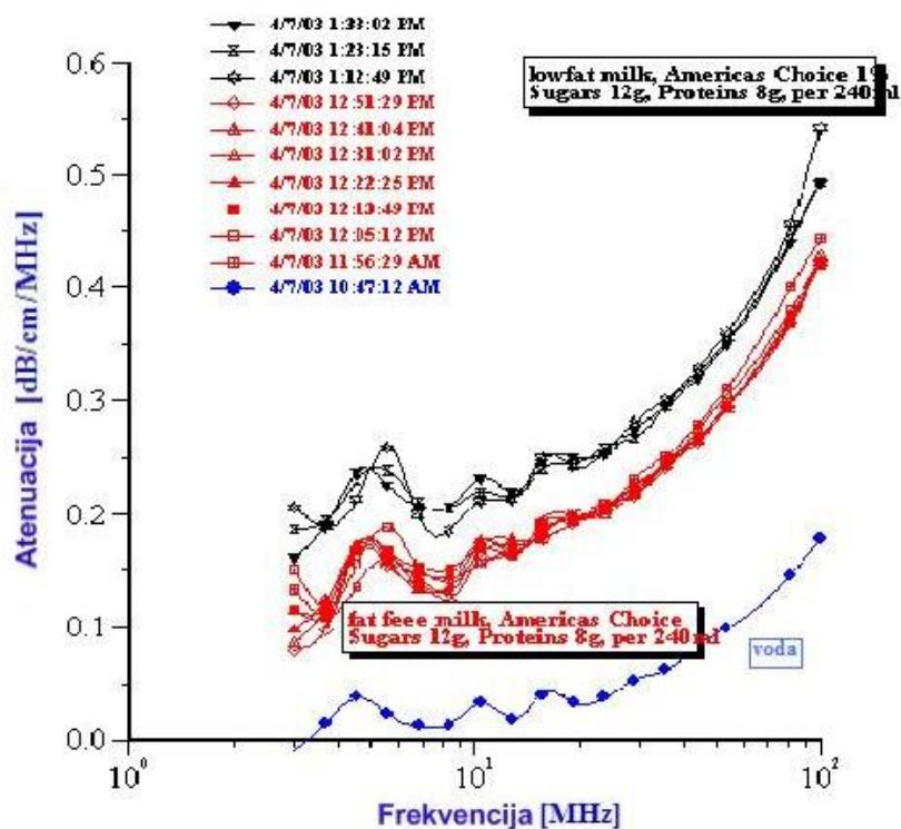
Slika 8. Atenuacijski spektri različitih koloidnih sustava i vode
