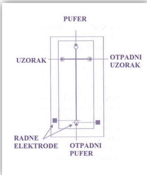
Slika 10. Shematski prikaz mikročipa [15].
