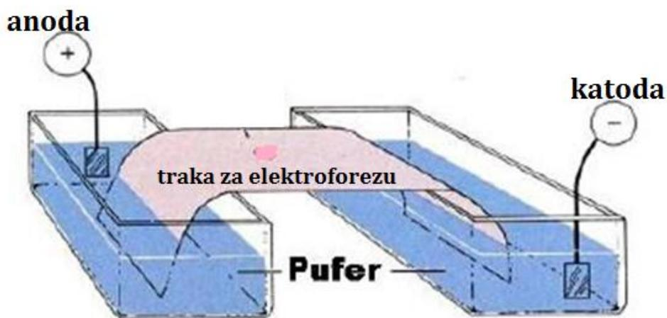
**Slika 1. Prikaz aparature za elektroforezu.**
