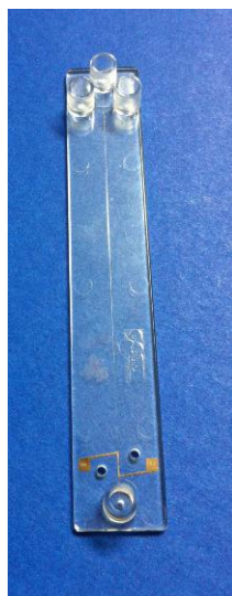
Slika 15. Prikaz oblika čipa s natiskanim radnim elektrodama koji se koristio u ispitivanjima.
