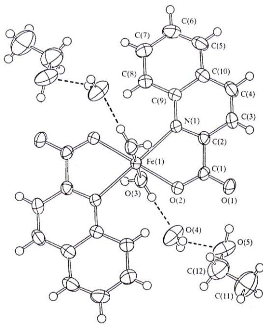
Slika 2.10. Molekulska struktura  $[Fe(C_{10}H_6NO_2)_2(H_2O)_2] \cdot 2C_2H_6O \cdot 2H_2O$
