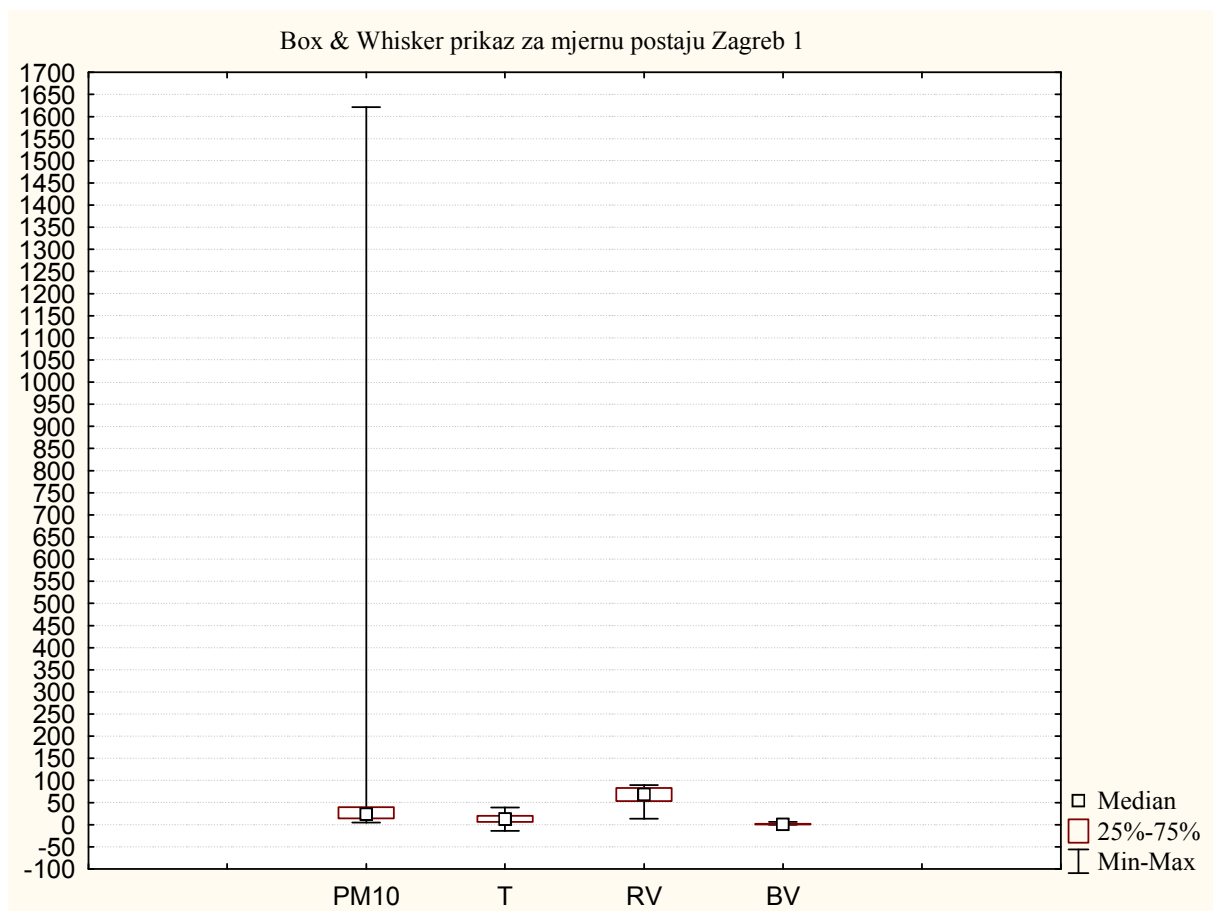
Slika 4.2.1– 1 Box & Whisker dijagram koncentracija PM10, temperature (T), relativne vlage (RV) i brzine vjetra (BV) za period siječanj 2007. – siječanj 2013. na mjernoj postaji Zagreb 1
