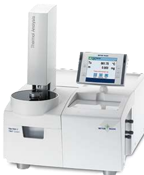
Slika 11 Prikaz TG/DSC aparature
