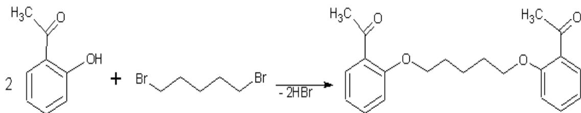
Slika 12 Prepostavljena struktura produkta S101
