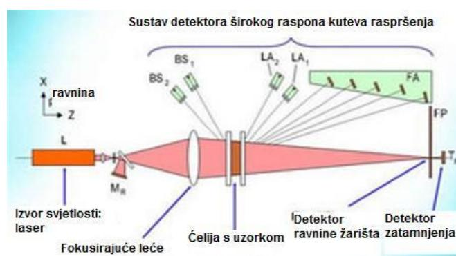
Slika 7. Shema aparature za lasersku difrakciju
