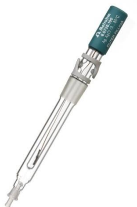
Slika 28. Referentna srebro/srebrov (I) klorid elektroda [13]
