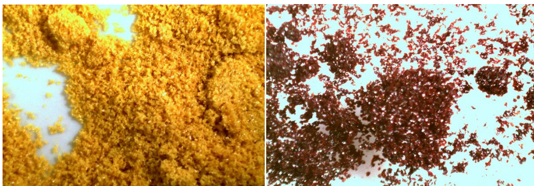
Slika 22. Kristali spoja p-DI a) prije i b) nakon jednodnevnog izlaganja parama \text{NO}_2
