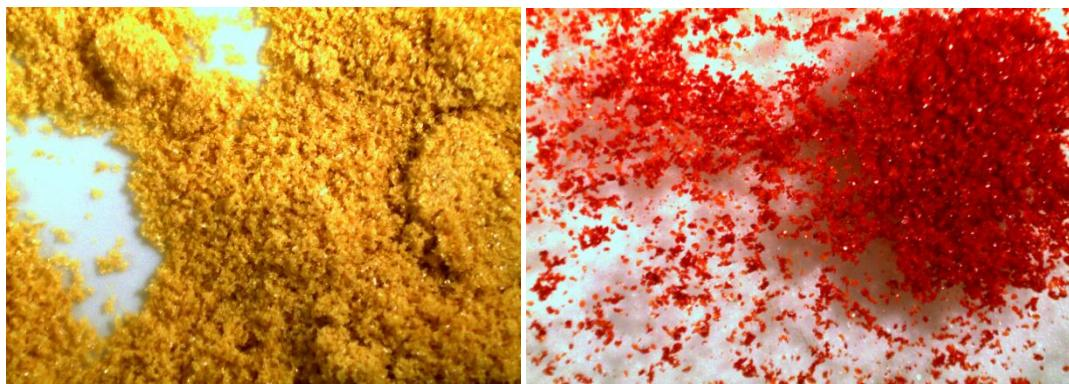
Slika 21. Kristali spoja p-DI a) prije i b) nakon jednodnevnog izlaganja parama  $\text{CO}_2$
