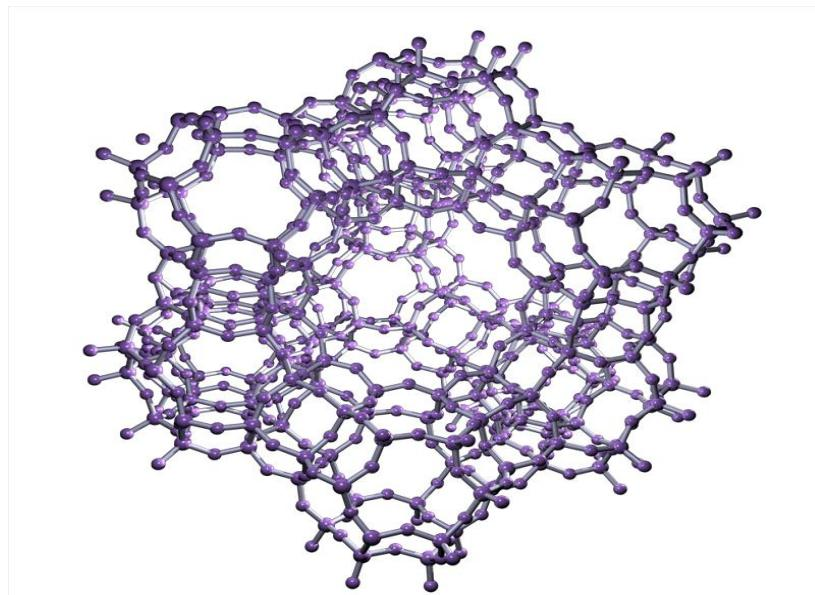
Slika 2. Trodimenijski prikaz strukture zeolita [6]
