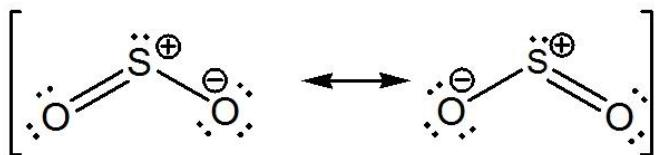
Molekula  $\text{SO}_2$  ima V – oblik i Lewisovom strukturnom formulom se piše kao rezonantna struktura.
