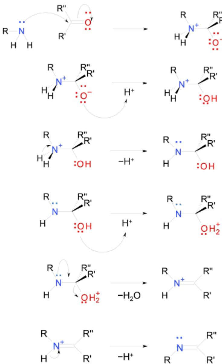
Slika 5. Shematski prikaz mehanizma nastajanja Schiffove baze reakcijom kondenzacije karbonilnog spoja i primarnog amina
