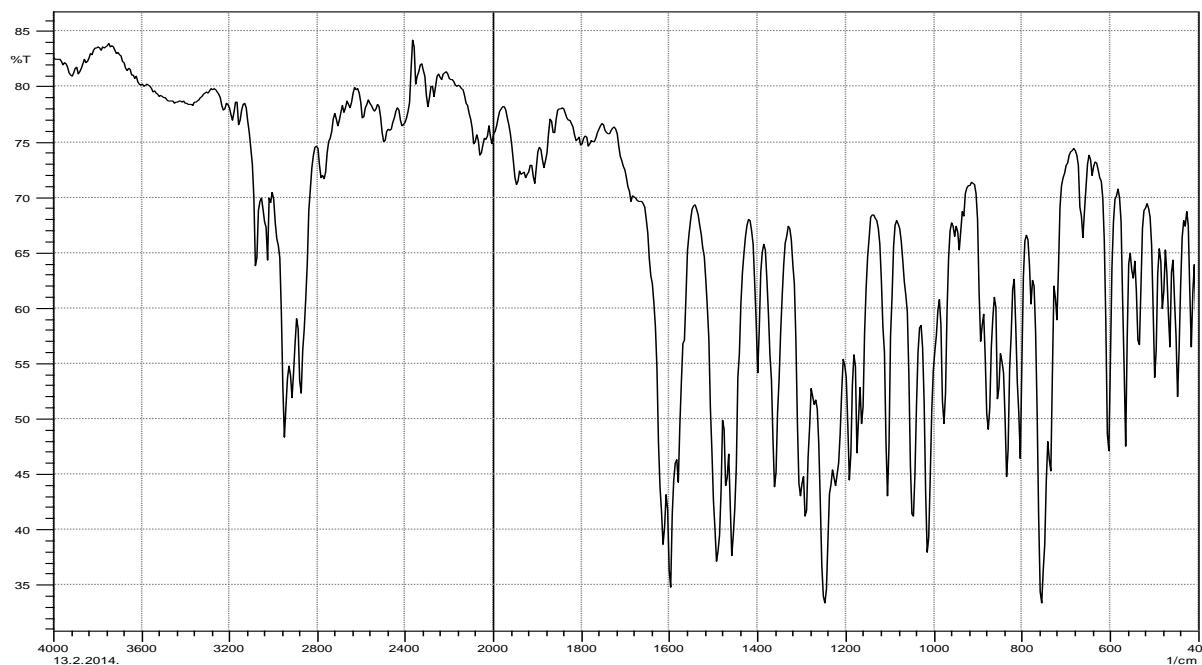
Slika 26. FT-IR spektar p-D1 s adsorbiranim I<sub>2</sub>
