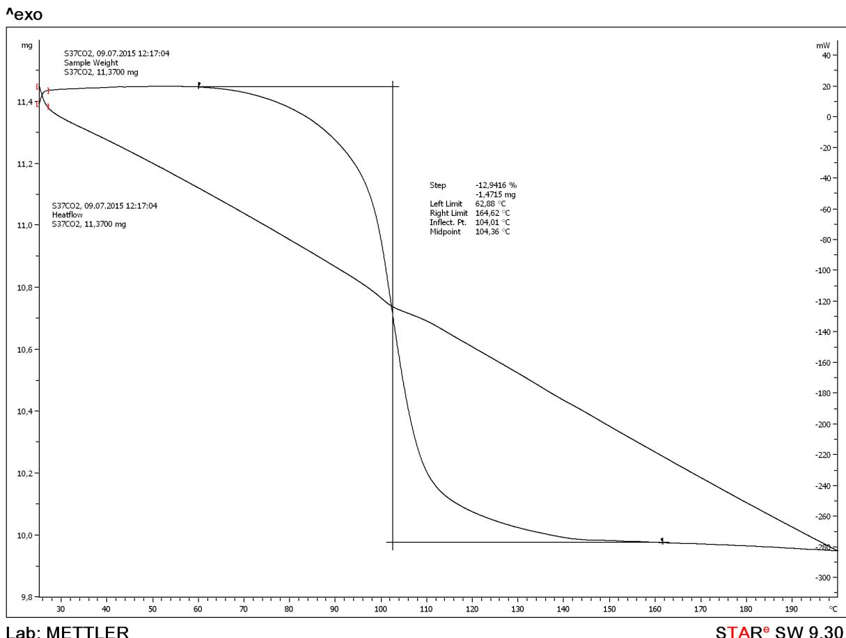
Slika 30. Rezultati TGA analize p-D1 s adsorbitanim  $CO_2$
