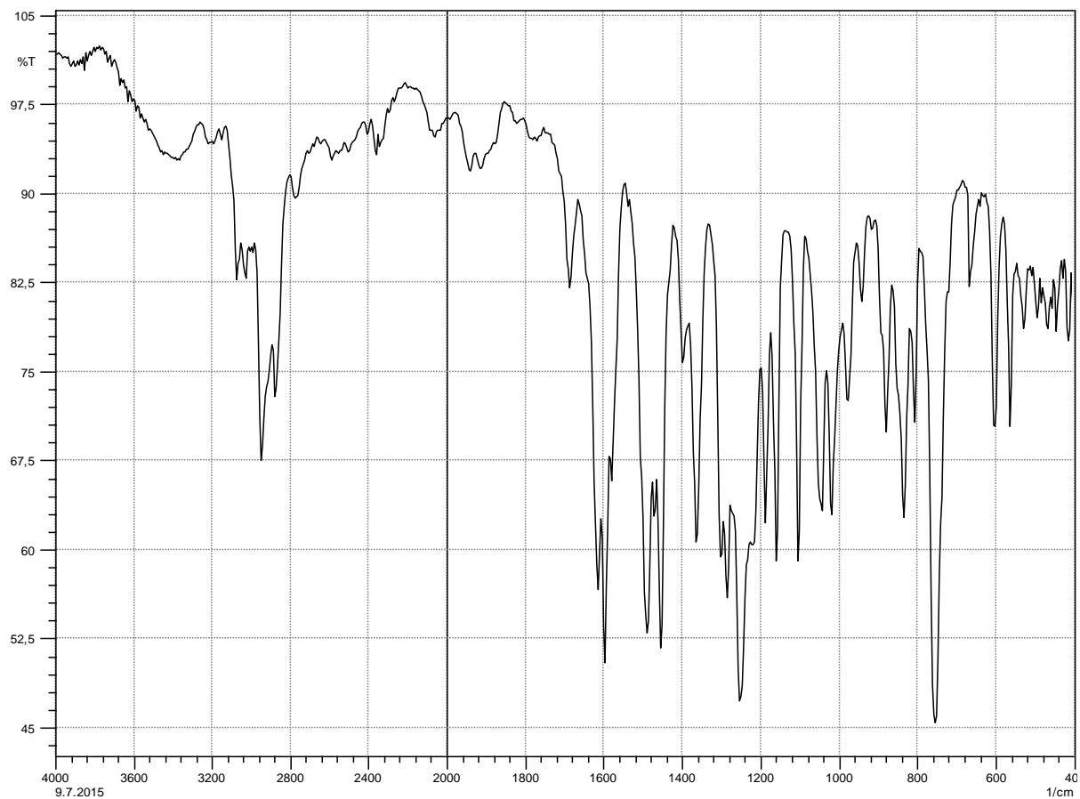
Slika 29. *FT-IR spektar makrocikličke Schiffove baze p-D1 s adsorbiranim CO<sub>2</sub>*
