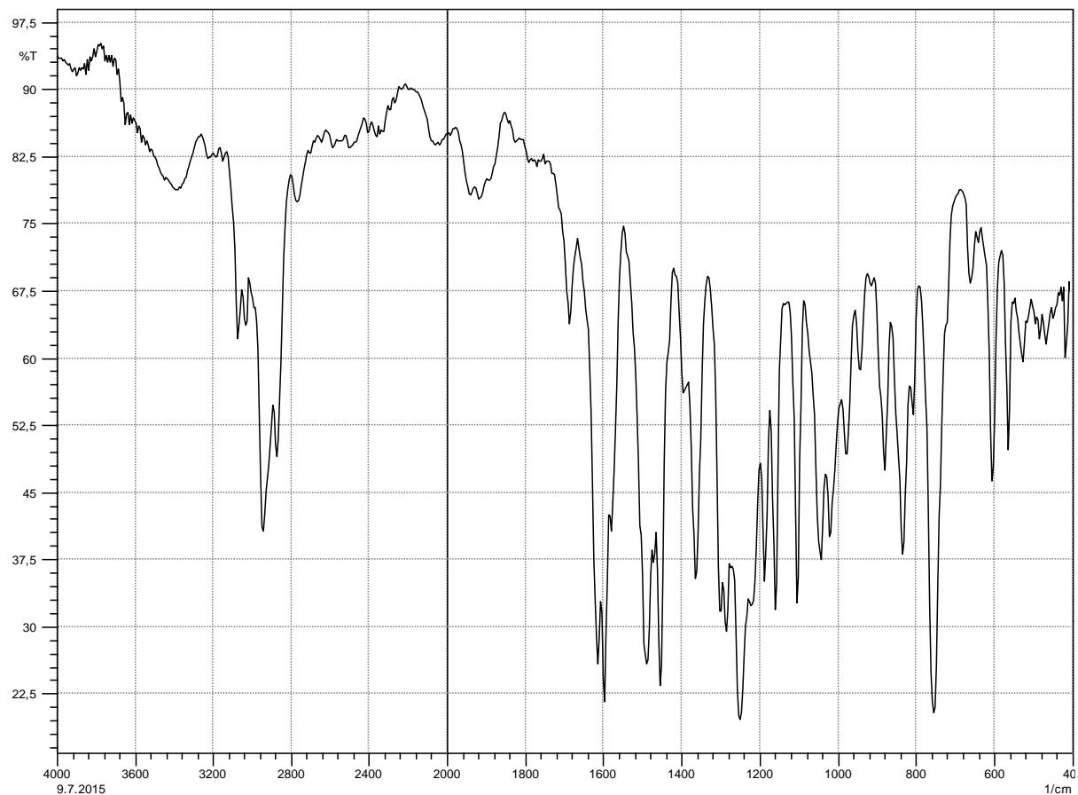
Slika 33. IR spektar makrocikličke Schiffove baze *p*-D1 s adsorbiranim SO<sub>2</sub>
