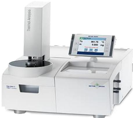
Slika 15. Prikaz TGA DSC aparature - Mettler Toledo TGA
