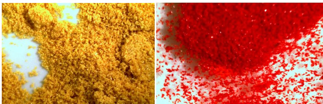
Slika 23. Kristali spoja *p*-D1 a) prije i b) nakon jednodnevног izlaganja parama SO<sub>2</sub>
