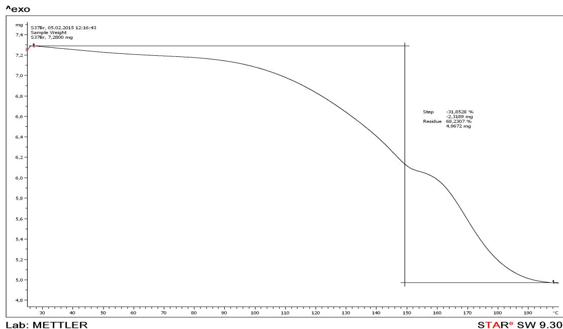
Slika 28. Rezultati TGA analize *p*-D1 s adsorbiranim Br<sub>2</sub>
