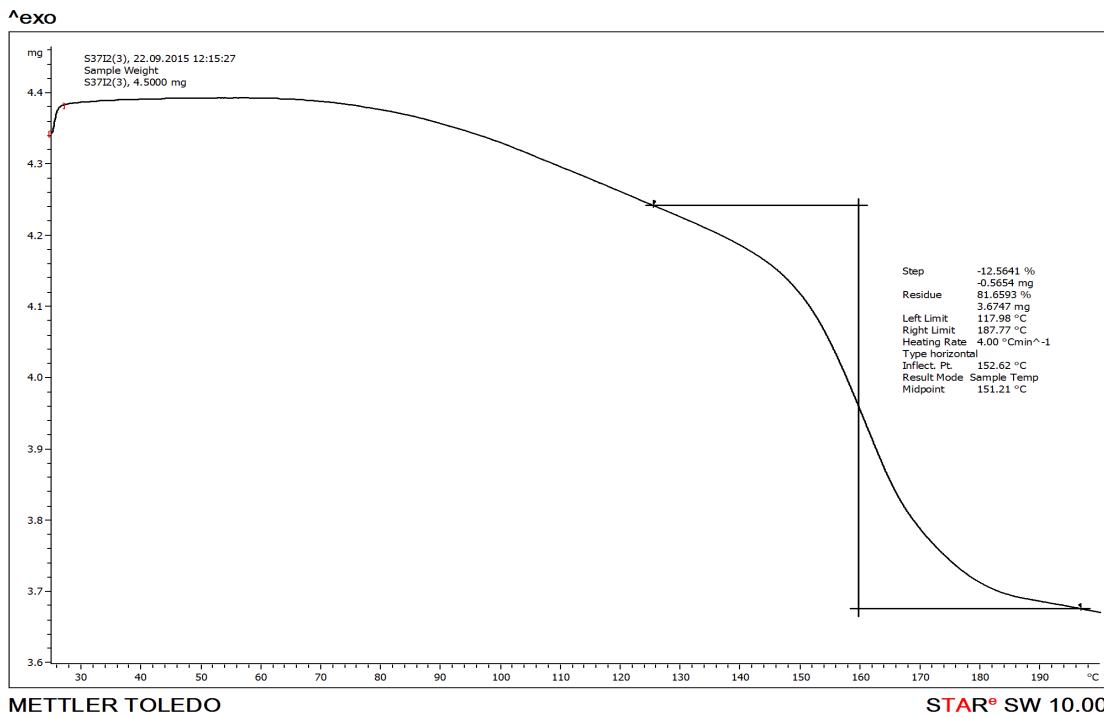
Slika 27. Termogram p-D1 s adsorbiranim jodom
