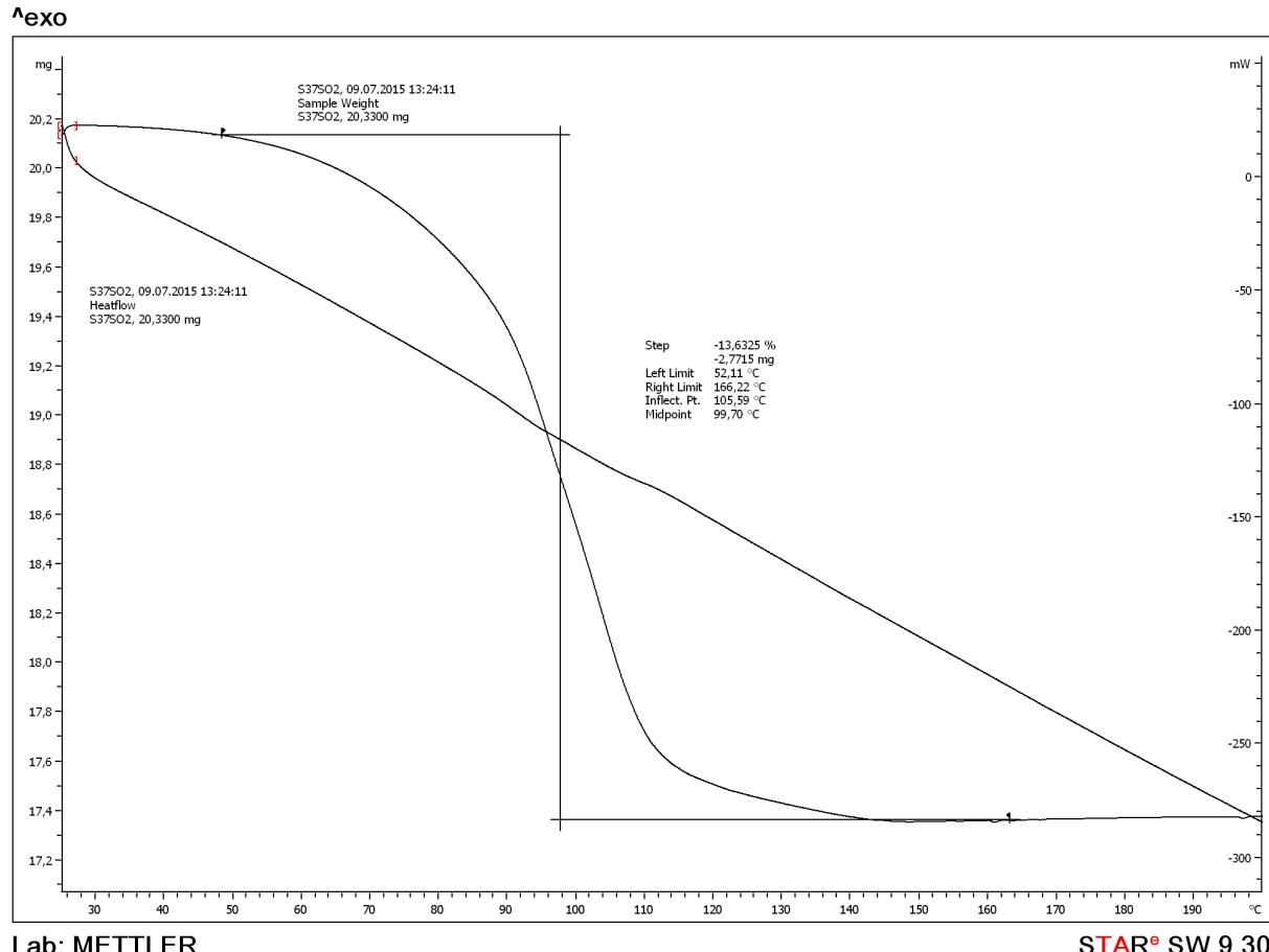
Slika 34. Rezultati TGA analize *p-DI* s adsorbiranim SO<sub>2</sub>
