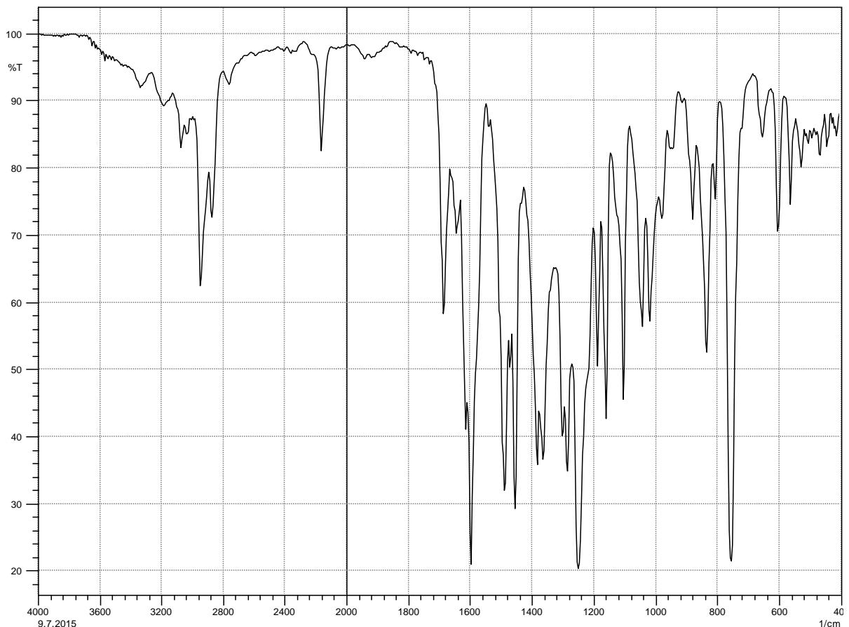
Slika 31. FT-IR spektar makrocikličke Schiffove baze *p*-D1 s adsorbiranim NO<sub>2</sub>
