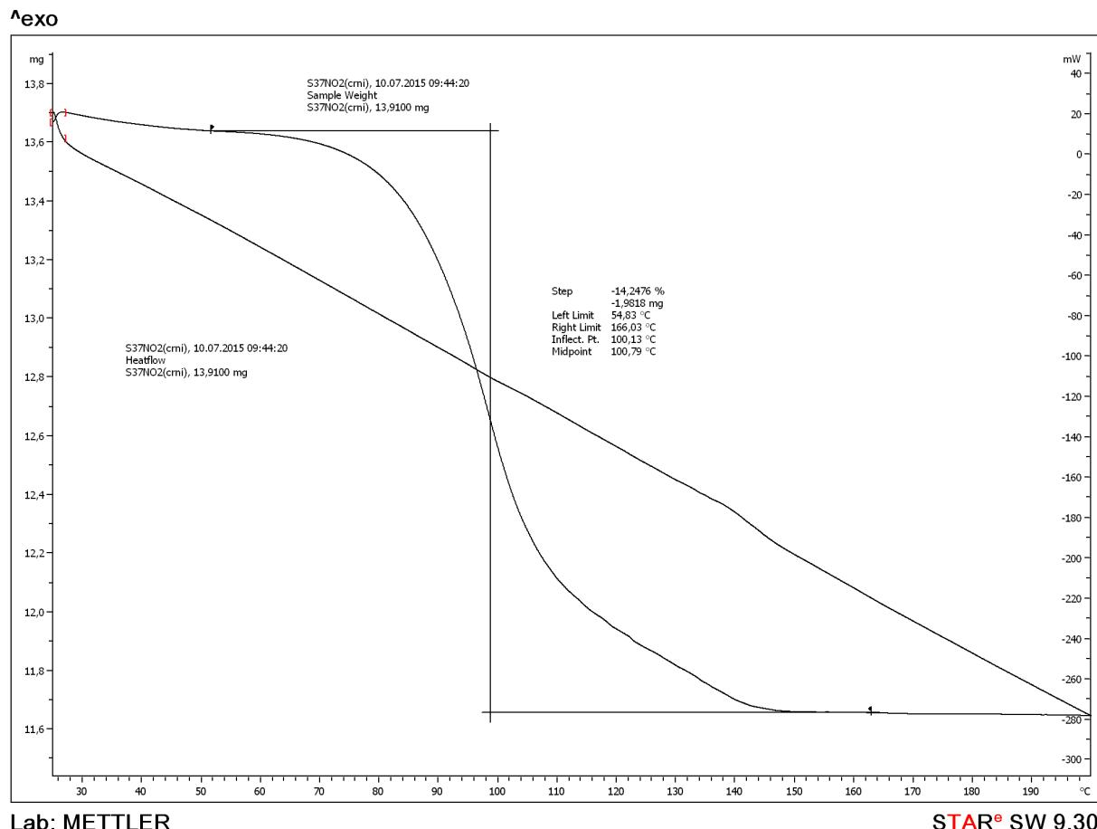
Slika 32. Rezultati TGA analize p-D1 s adsorbiranim NO<sub>2</sub>
