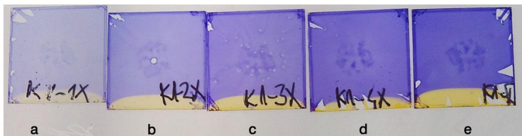
**Slika 4.2.** Sol-gel senzorske pločice s indikatorom BCP.
