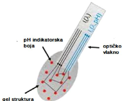
2.12. Shema optičkog sol-gel senzora za određivanje pH [45].
