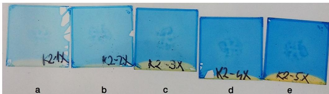
**Slika 4.3.** Sol-gel senzorske pločice s indikatorom BCG.
