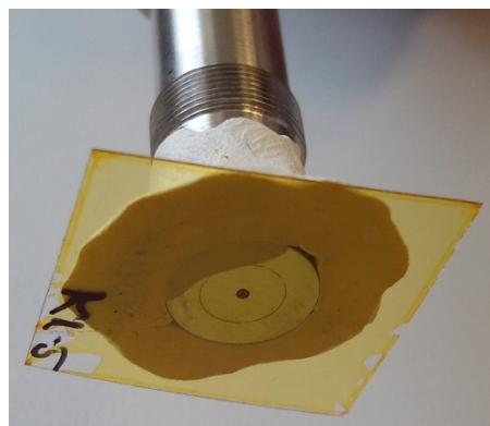
**Slika 3.3.** Senzorska pločica fiksirana na sondi.
