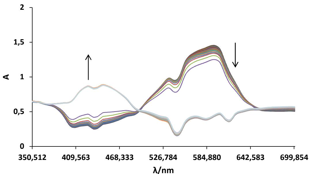
**Slika 4.16.** Promjena apsorpcijskih spektara prilikom titriranja otopine  $\text{NaOH}$  s otopinom  $\text{HCl}$  uz korištenje K1-5X senzorskog sloja.
